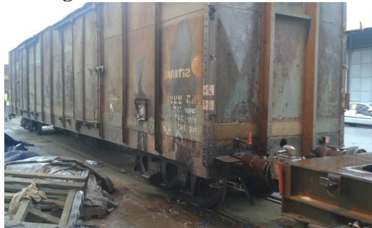
Photo n°2 : Wagon couvert de la SITARAIL mal entretenu
